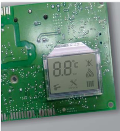
Scheda elettronica Unical HONEYWELL con microprocessore
