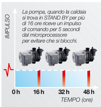
Temporizzatore antibloccaggio pompa
