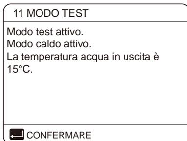
Durante il collaudo MODO CALDO, la temperatura predefinita dell'acqua in uscita è di 35°C. L'IBH (riscaldamento di riserva interno) si accende dopo che il compressore funziona per 10 minuti. Dopo 3 minuti di funzionamento dell'IBH, l'IBH si spegne, la pompa di calore funziona fino a quando la temperatura dell'acqua non aumenta fino a un certo valore o fino a quando non si riceve il comando successivo.
