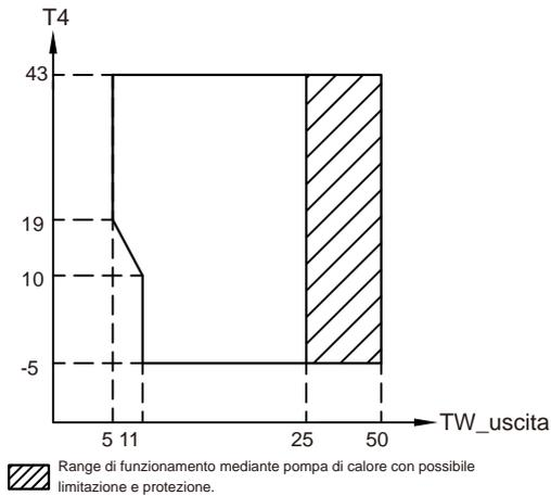
Nella modalità di riscaldamento, il range della temperatura di scorrimento dell'acqua (T1) con diverse temperature ambiente (T4) viene elencato qui di seguito:
