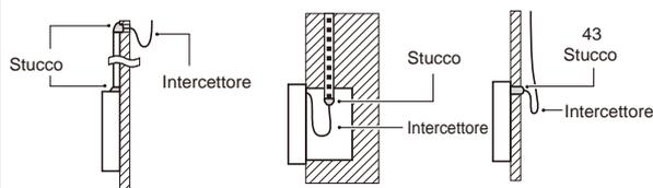
Evitare che l'acqua entri nel telecomando cablato, usare sifone e mastice per sigillare i connettori dei fili durante l'installazione del cablaggio.
