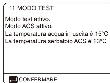
Durante il collaudo MODALITÀ ACS, la temperatura nominale predefinita dell'acqua sanitaria è di 55°C. Il TBH (tank booster heater - riscaldatore del booster del serbatoio) si accende dopo che il compressore funziona per 10 minuti. Il TBH si spegnerà 3 minuti dopo, la pompa di calore funzionerà fino a quando la temperatura dell'acqua non aumenterà fino ad un certo valore o fino al prossimo comando.
