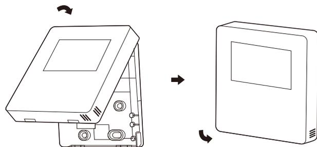
Installare correttamente il coperchio posteriore e fissare saldamente il coperchio anteriore e quello posteriore, altrimenti il coperchio anteriore cadrà.
