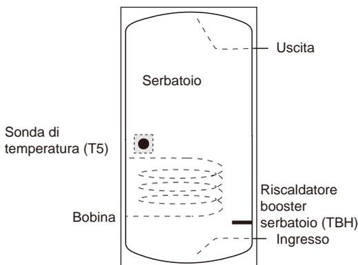
Il riscaldatore del booster deve essere installato sotto alla sonda di temperatura (T5).
