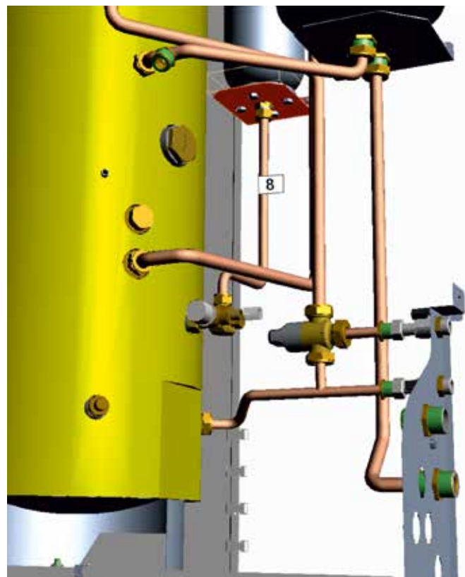
Collegare tubo 8 vaso esp. / valvola sicurezza
