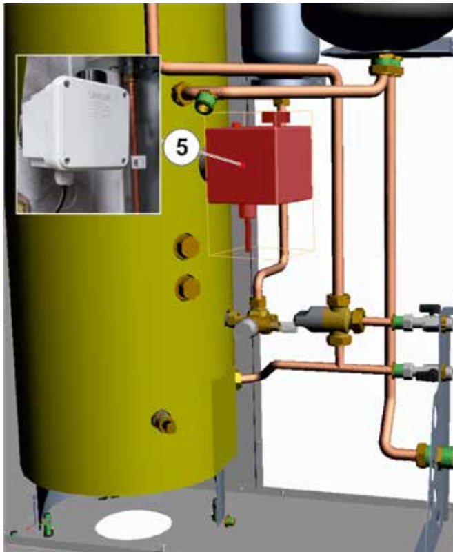
Inserire resistenza di integrazione 5 (Fissare con teflon, canapa, pasta idraulica)
