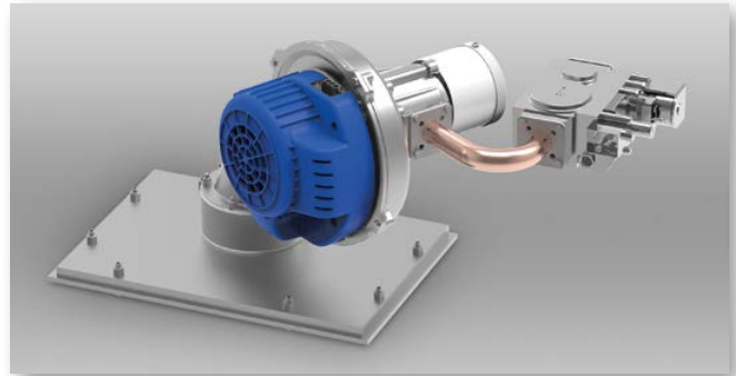
Vormisch-Brenner mit gleichbleibender CO 2 -Emission (modulierendes Gasventil, modulierende Gebläse und Edelstahlbrenner)
