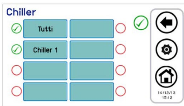
Figura 36. Scelta plurima chiller, funzione massetto
