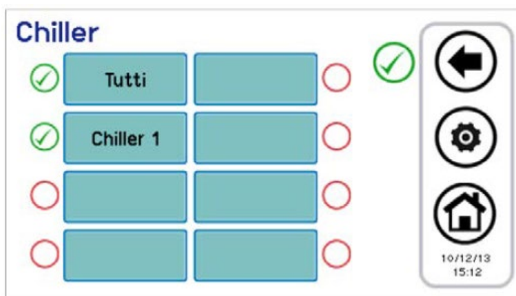
Figura 23. Scelta chiller/pompe di calore per produzione ACS
