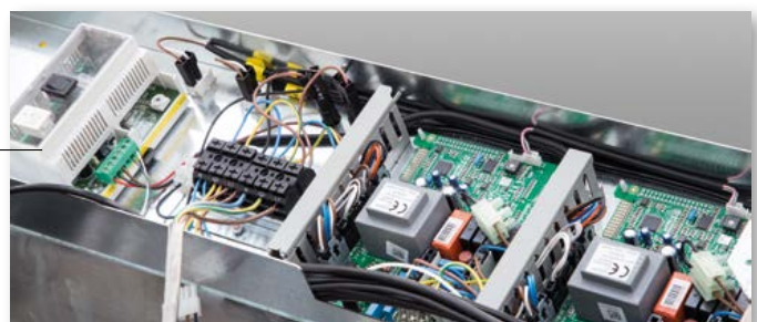
Anordnung der Platinen für die Steuerung der Heizelemente und BCM 2.0
