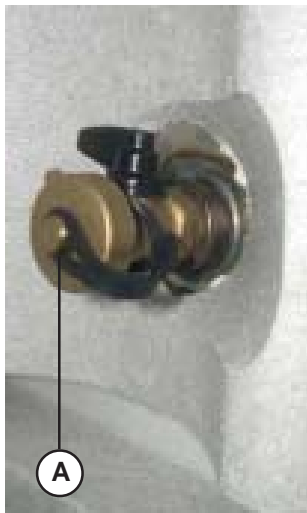
Rubinetto di scarico normale funzionamento
